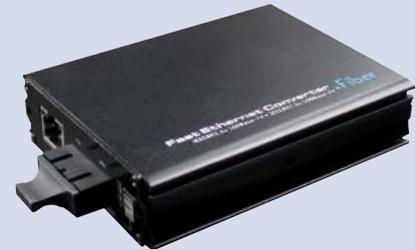
**Convertidor fibra óptica SC a ethernet, 100Mbps**
